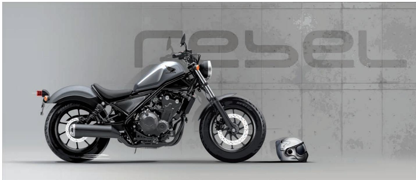
Développant 33,5 kW le bicylindre de 500 cm<sup>3</sup> est adapté aux détenteurs du permis A limité. Le couple a été travaillé pour améliorer la disponibilité et le coffre du moteur.
