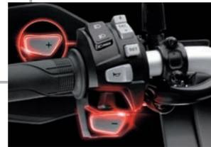
◀ À gauche, les boutons + et - permettent de changer de rapport manuellement.
